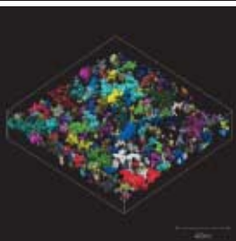
タイヤ材料中のシリカの分散改良 (三次元電顕写真の画像処理による、ブリヂストン提供)
